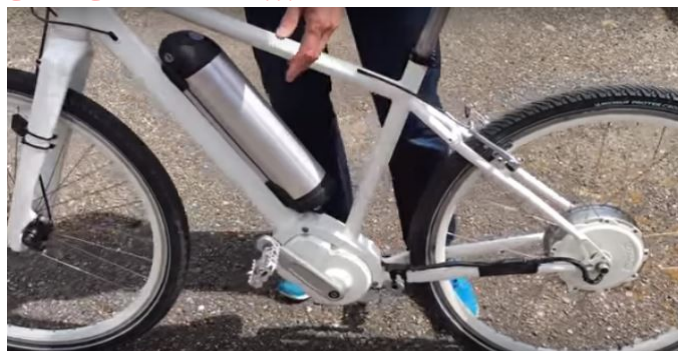
Le pédalier actionne une dynamo qui alimente le moteur dans l'essieu arrière aidé par la batterie
